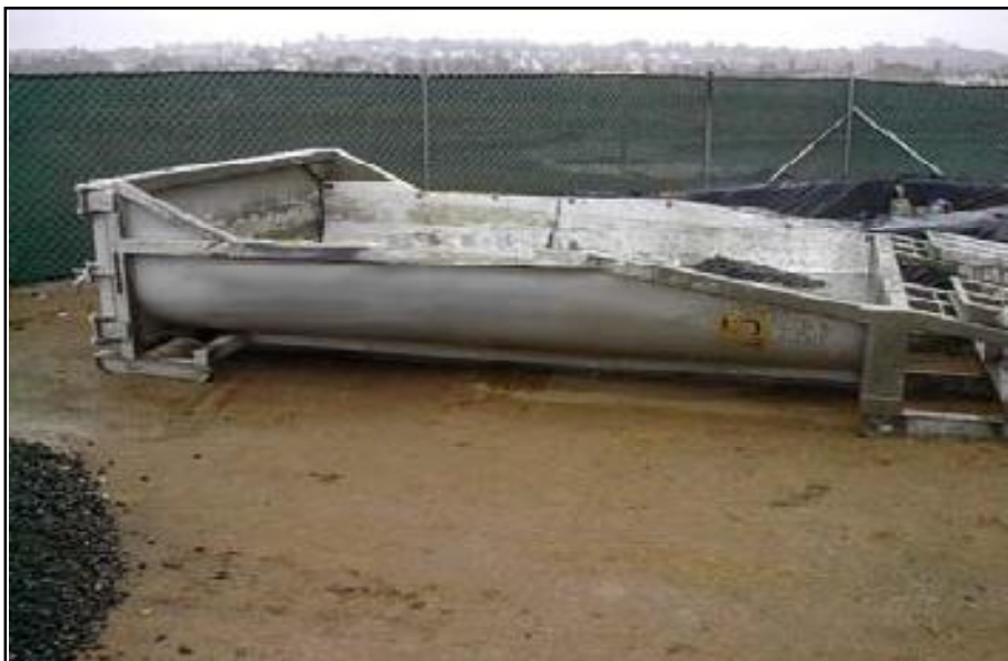
شکل ۵- تصویر یک نمونه محفظه پیش ساخته شستشوی بتن
