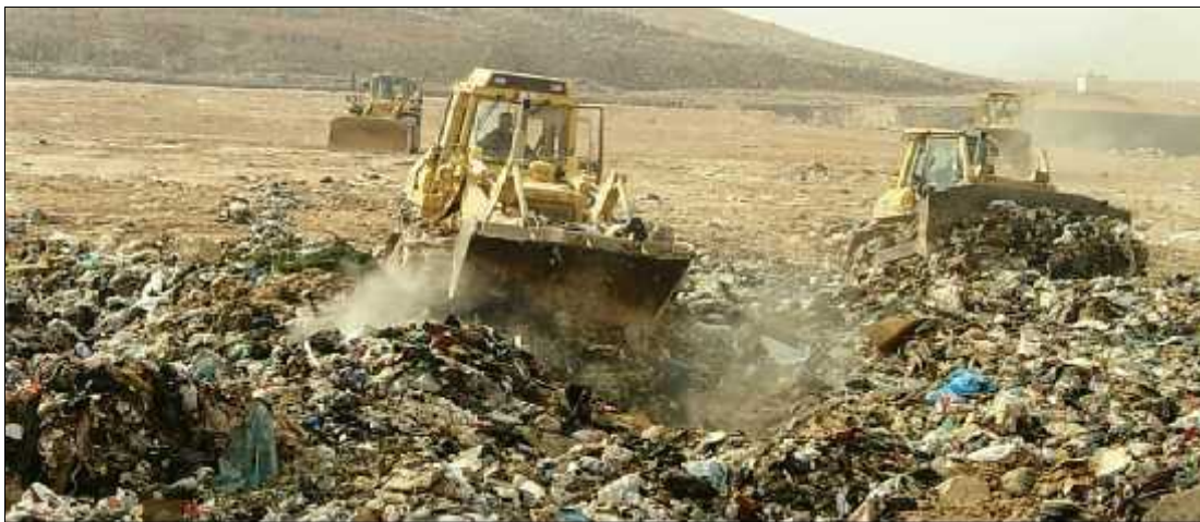
شکل ۶-۱- دفن در زمین نیازمند تجهیزات و ماشین‌های مناسب مانند لودر و بولدوزر است
